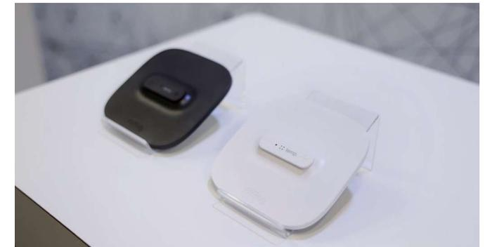
センサーデバイス「AirPlug™ Sense-T」。ワイヤレス給電で稼働するIoTセンサー。株式会社三菱UFJ銀行本部部署オフィスに導入されたものは、温度センサーに加え、位置情報もセンシングしている。
